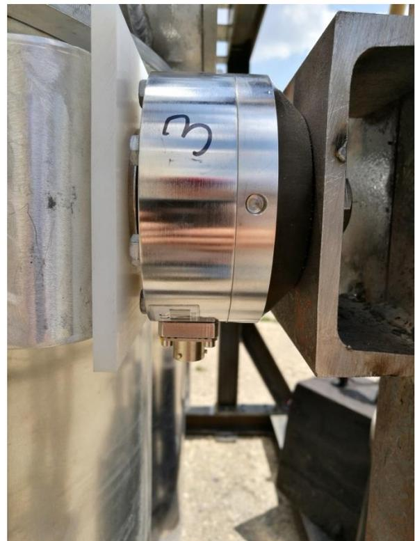
Bild 4: Kraftaufnehmer am vertikalen Schenkel
