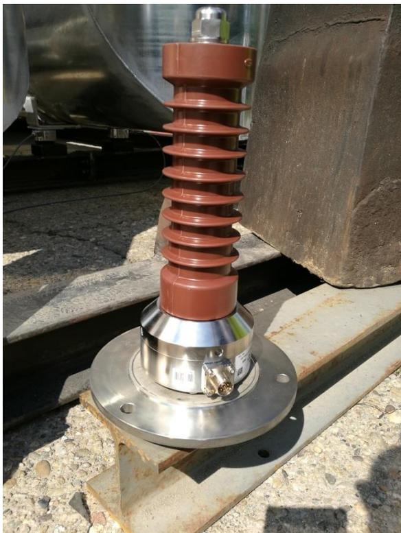
Bild 3: Stützer mit Kraftaufnehmer
