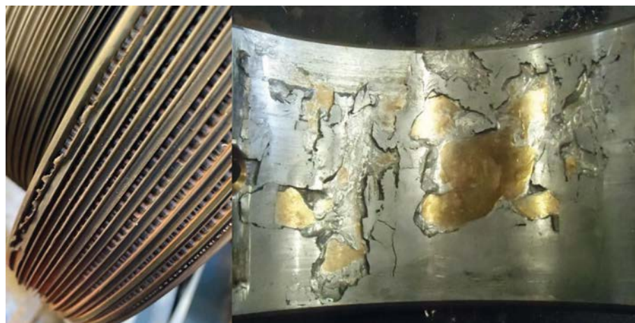
Bild 2. Schäden im Bereich von Labyrinthdichtungen und Gleitlagern aufgrund hoher Schwingungsamplituden im Betrieb, aber auch im Hoch- Auslaufbetrieb.
