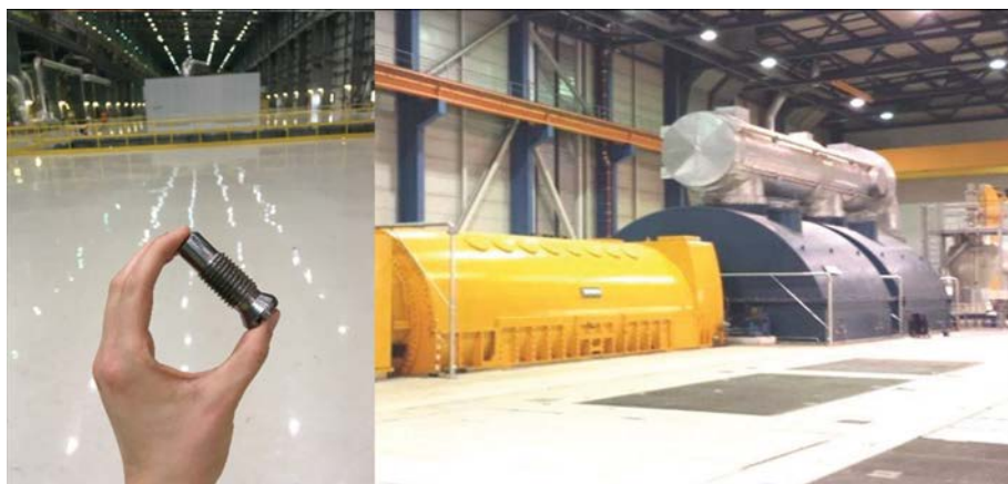
Bild 1. Kaum zu glauben, dass ein solch, kleines Wuchtgewicht das Schwingungsverhalten einer riesigen Turbine nachhaltig verbessern kann! Eine kleine Masse, richtig angewendet kann eine große Wirkung entfalten.
