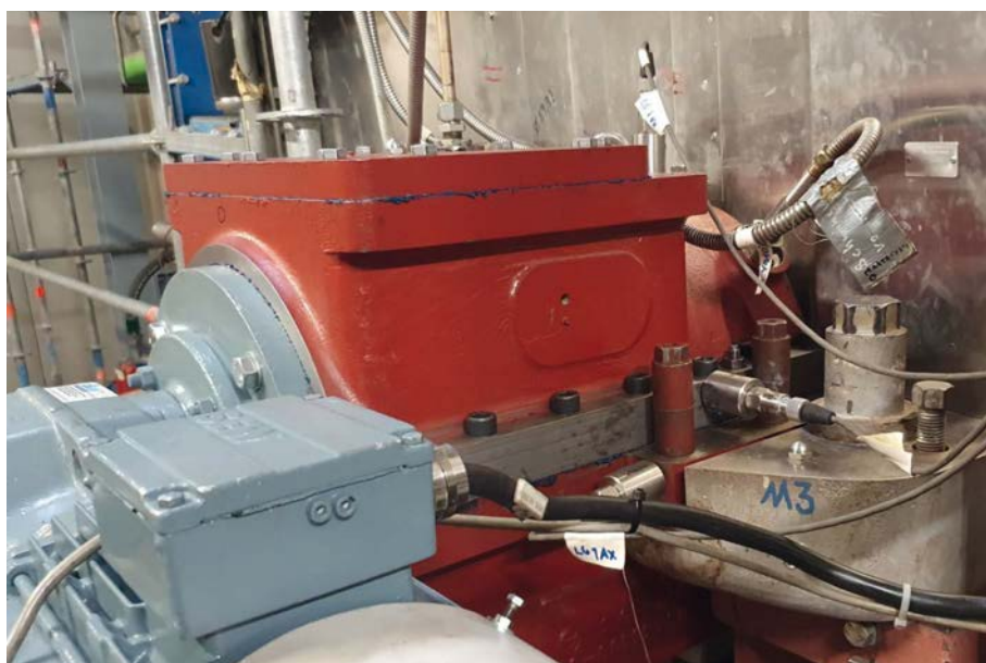
Bild 4. Zusätzliche, temporäre Gehäuseschwingungssensoren am vorderen Lager einer Industrieturbine mit 7 MW elektrischer Leistung. Die Anbringung der Sensoren in vertikaler horizontaler und axialer Richtung entspricht der Empfehlung der DIN ISO 20816-1 bzw. -3
