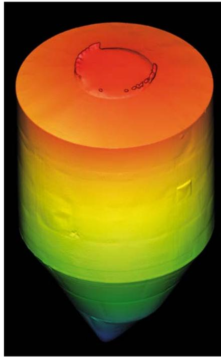
Bild 4. Aus den während des Fluges gewonnenen Daten lässt sich dank der zugehörigen Software ein exaktes 3D-Modell generieren. Hier deutlich zu sehen die Verformungen in einem zylindrischen Sprühabsorber.
