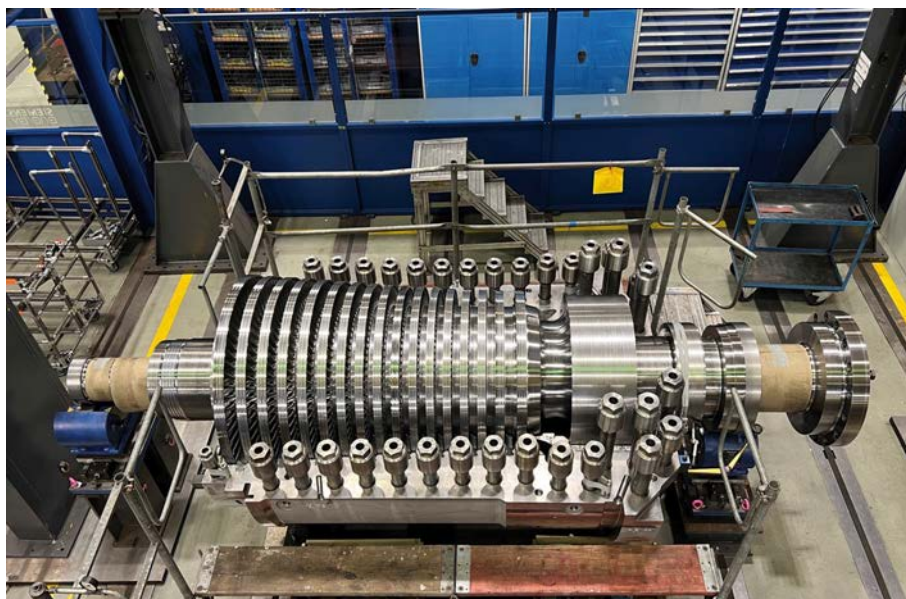
Bild 6. HD-Innenblock bei der Spielmessung im Werk Mülheim von Siemens Energy.
