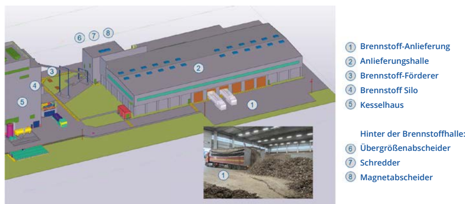
Bild 2. Brennstoff-Lager und Brennstoff-Transport.
